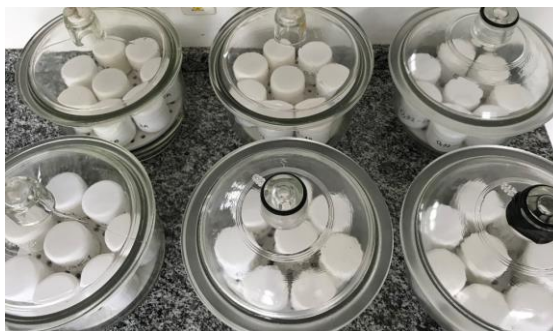
Figura 11. Acondicionamento das amostras nos dessecadores no estudo de isotermas de sorção.
