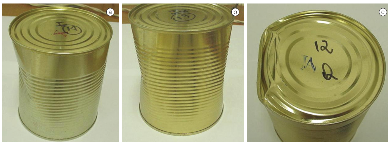
Figura 1. Fotografias das latas de pêssego em calda após impactos I (a), I_2 (b) e Q (c).
