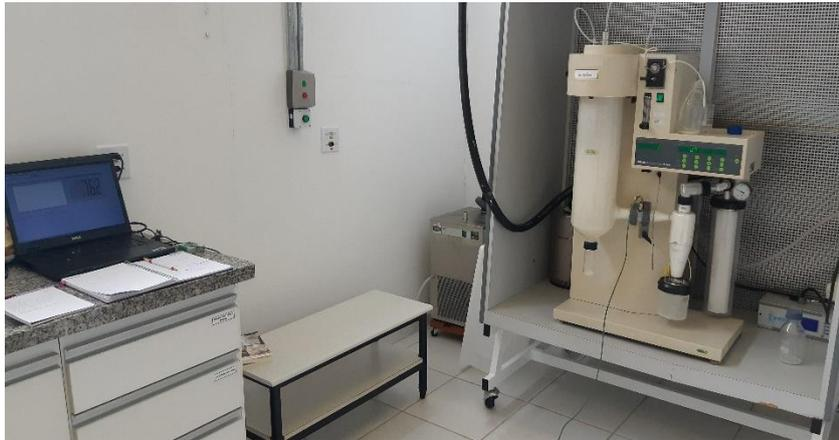
Mini spray dryer Buchi B-290 e o termopar conectado ao computador para monitorar temperatura de saída.
