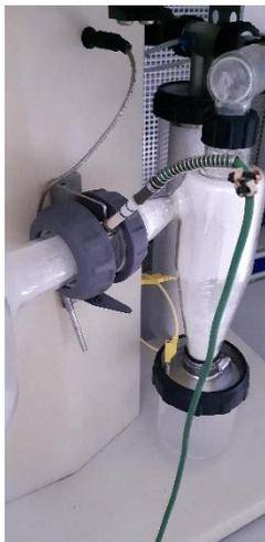
Termopar acoplado ao equipamento.
