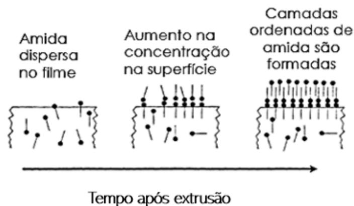
**Figura 9** - Diagrama esquemático da migração da erucamida para a superfície do filme plástico (Adaptado de MALTBY; MARQUIS, 1998).
