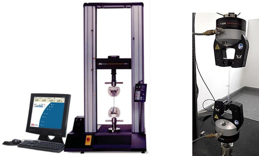
**Figura 16** - Máquina universal de ensaios Instron e detalhe das garras utilizadas no ensaio de resistência da termossoldagem à tração (Autora).
