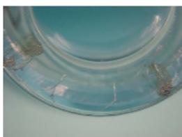
Figura 4. Microfissura localizada sobre a  rea de veda o da termina o do frasco de vidro tipo I de 4 mL/13 mm. Imagem obtida em estereomicrosc pio, com aumento de imagem de 18 vezes.
