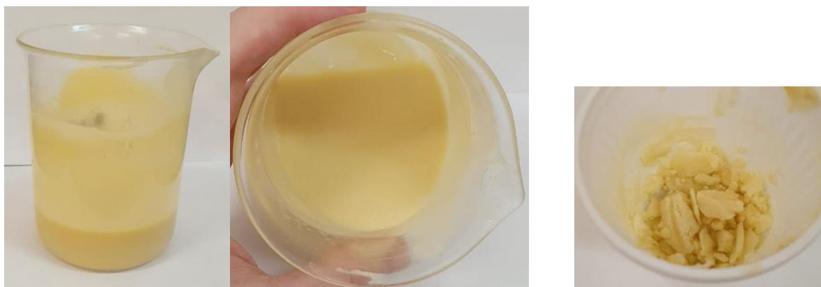
Figura 12 - Imagens do bigel obtido no teste 2, com a lecitina de soja e sem o extrato, (a) logo após elaboração e (b) após cristalização a 5°C por 24h e 25°C por 24h.
