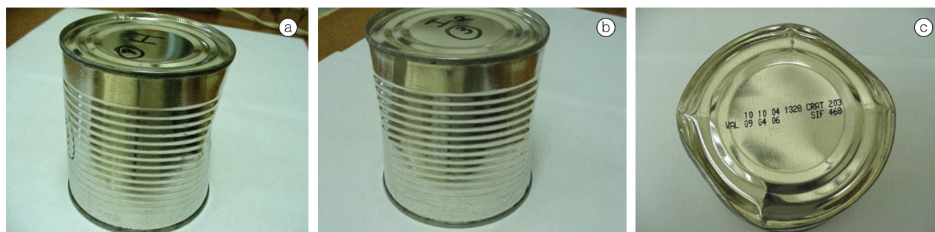
Figura 2. Fotografias das latas de creme de leite após impactos a) I, b) I 2 e c) Q.
