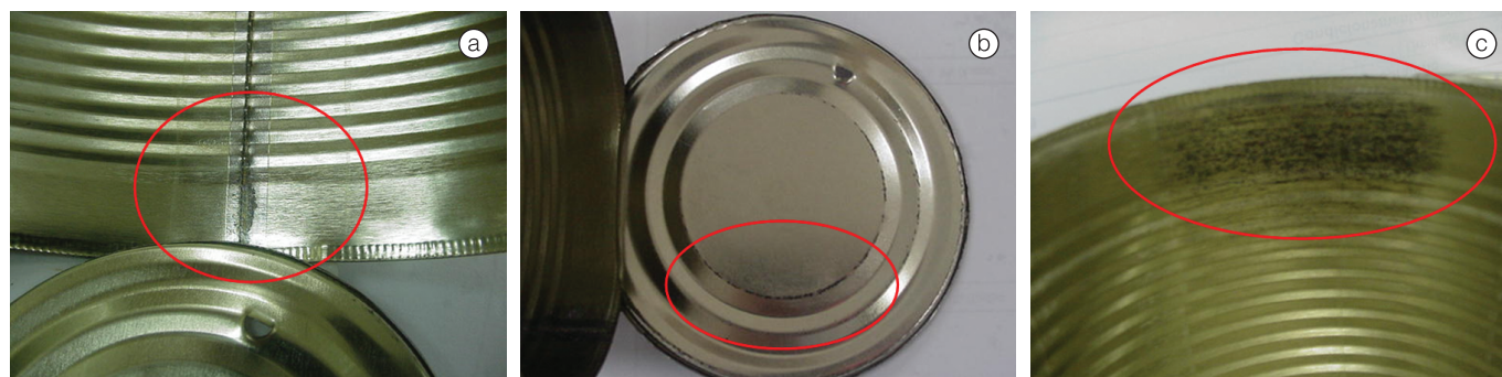
Figura 4. Exemplos da superfície das latas de creme de leite após estocagem por 365 dias a 35 °C: a) solda, b) tampa com oxidação no anel de expansão, c) corpo.
