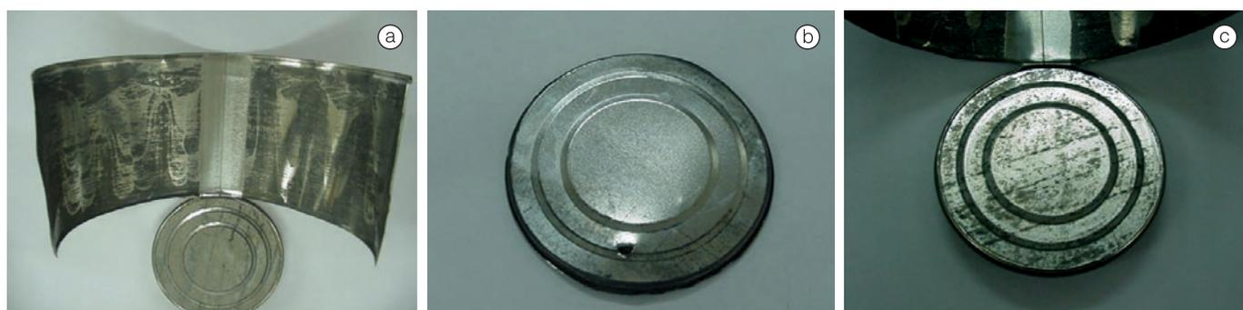
**Figura 2.** Fotografias ilustrando a superfície interna das latas SV após 180 dias de estocagem a 40 °C: (a) corpo, (b) tampa, (c) fundo.
