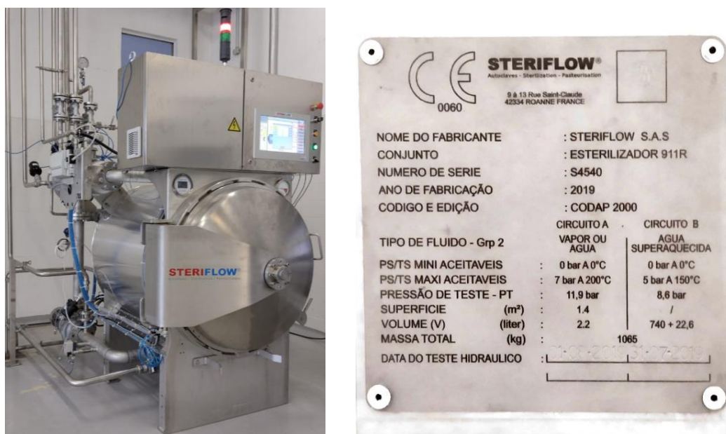
Figura 6 – Autoclave piloto Steriflow onde os testes de penetração foram conduzidos; Especificações da autoclave piloto Steriflow.
