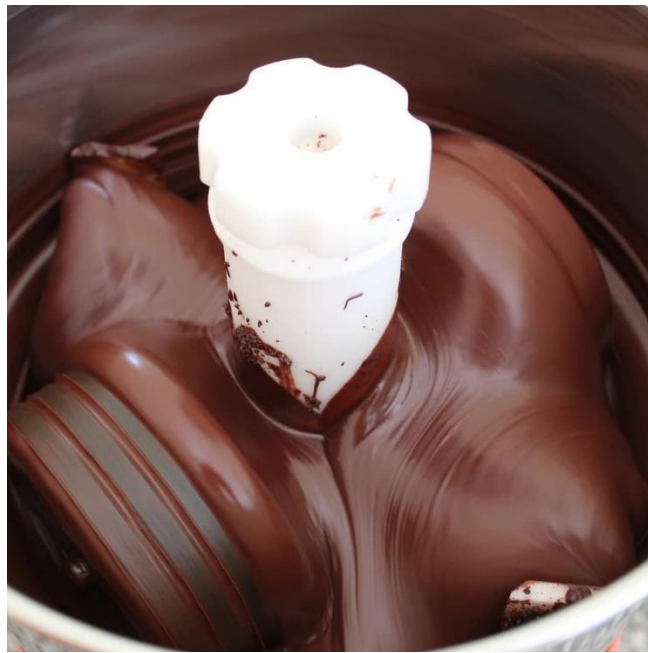
Figura 17. Melanger realizando refino e conchagem (Fonte: próprio autor)
