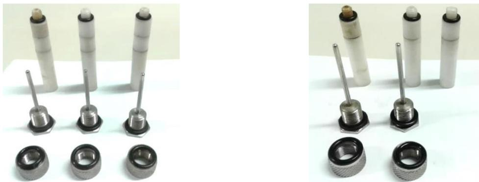
**Figura 6.** Montagem de espaçadores, poços de 35 mm (à esquerda) e 40 mm (à direita).
