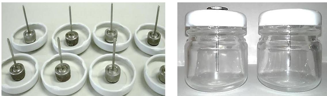
**Figura 7.** Instrumentação de tampas com poços para introdução de termopar (à esquerda) e frascos com poços de 40 mm e 35 mm.
