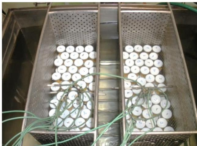
**Figura 11.** Instrumentação dos frascos para a aquisição das temperaturas (cesto 1, à esquerda e cesto 2, à direita).
