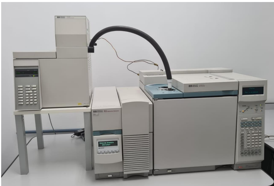
Figura 7. Cromatógrafo a gás com detector espectrômetro de massas e sistema automático de amostragem “Headspace”.
