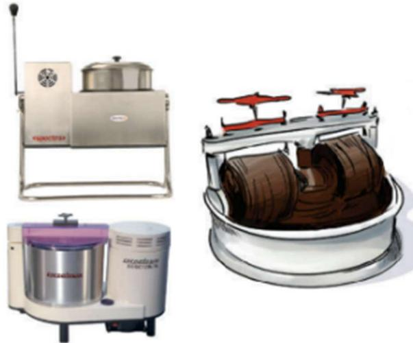
**Figura 5.** Melanger, máquina utilizada na etapa de refino do chocolate "*Bean to bar*"
