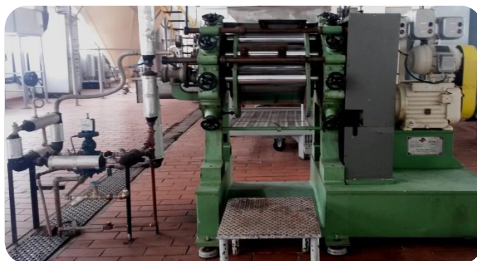
Figura 3.1 Secador de cilindro rotativo da Planta Piloto de Desidratados do Fruthotec / ITAL.
