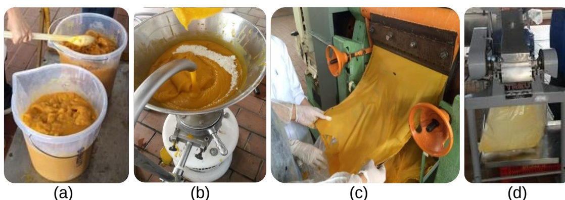
Figura 3.2 Etapas do preparo da polpa para a obtenção da fruta em pó: a) descongelamento da polpa de manga; b) homogeneização da polpa e dos coadjuvantes; c) secagem da polpa homogeneizada no drum dryer ; d) moagem do produto seco.
