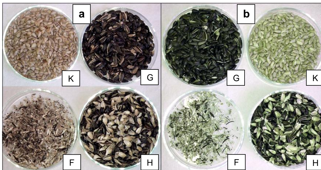
Figura 4. Comparação das quantidades obtidas de finos (F), amêndoas (K), grãos não descascados (G) e cascas (H) na primeira etapa de descasque para F predito de 5% b.s. (a) e F predito de 2% b.s. (b) .
