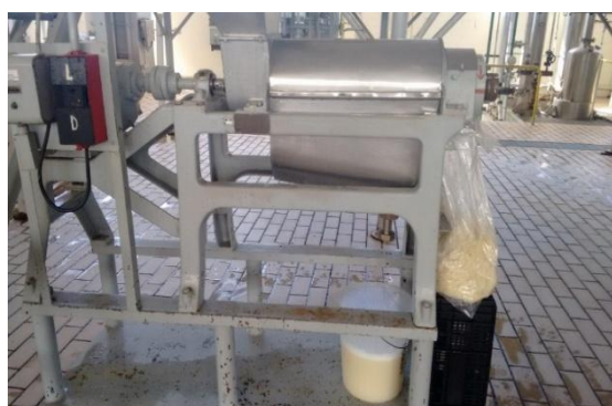
Figura 5. Despolpamento do produto em despulpador de rosca sem fim (Finisher)
