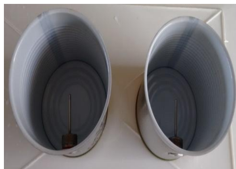
Figura 12. Lata com poço para introdução dos termopares
