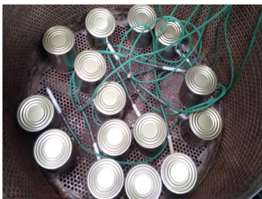
Figura 13. Instrumentação das latas com poços e termopares
